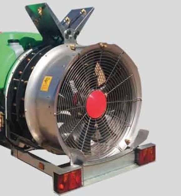
● **HÉLICE:** Diamètre 920mm, lames avec pas variable et progressive en 8 positions (25 ° à 45 °) Profil SICKLE fdv polyamide renforcé, faible consommation d'énergie et de haute performance. Embryage centrifuge 3 patins de frein.
